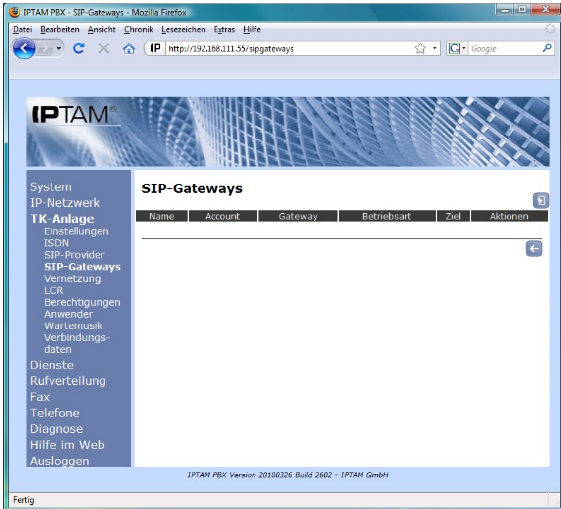
Abbildung 14.1: Übersicht der in der Anlage eingerichteten SIP-Gateways
